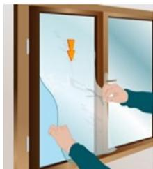
Pour diminuer les pertes de chaleur à travers les châssis, on peut : appliquer un **film thermo-rétractable** devant les vitres, mais aussi calfeutrer les fentes entre les parties fixes et mobiles des châssis en collant un **tape** bon marché, invisible et facilement décollable vendu en pharmacie. Un autre moyen efficace est d'utiliser de **lourdes tentures**, en veillant à les faire retomber derrière le haut des radiateurs, pour ne pas empêcher la chaleur de circuler.
