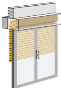
Une partie de la perte de chaleur peut provenir des courants d'air qui passent par le caisson contenant l'enrouleur du volet. Pour isoler des courants d'air, on peut calfeutrer l'intérieur du caisson, par exemple en utilisant un **panneau de verre cellulaire** (« foam glass ») d'une épaisseur d'1 à 2 cm. Attention à maintenir l'espace nécessaire à l'enroulement complet du volet.
